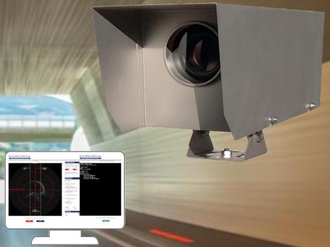
L<sub>20</sub>-Leuchtdichte-Sensoren erfassen - aus dem Abstand der Haltesichtweite - die mittlere Leuchtdichte des Tunnelumfeldes als Sollwert der Lichtregelung.
